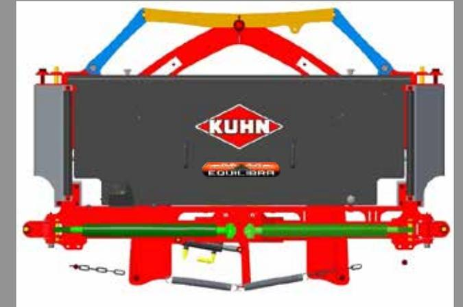
La suspensión de péndulo y bieletas permite muchos movimientos de las barras, especialmente movimientos de traslación para mantener las barras estables.
