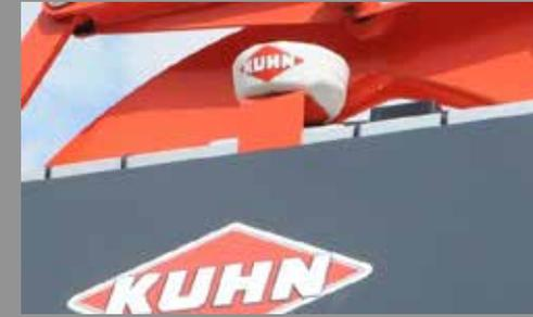
Antena colocada en el marco central: mide la posición de la boquilla
