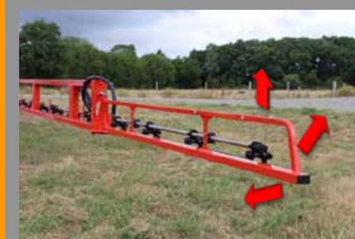
El brazo de seguridad se puede mover en las 3 dimensiones. La tubería está protegida desde el frente y la parte inferior del brazo.
