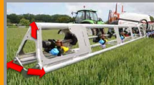
El brazo de seguridad se puede mover en las 3 dimensiones. La tubería está protegida desde la parte delantera, inferior y trasera del brazo.
